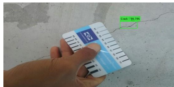
รูปที่ 4.8 ตัวอย่างผลลัพธ์การตรวจจับ Crack
