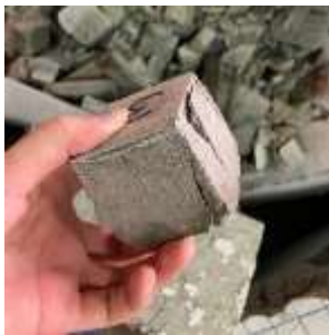
รูปที่ 10 พฤติกรรมการวิบัติของชิ้นตัวอย่างทรงลูกบาศก์
