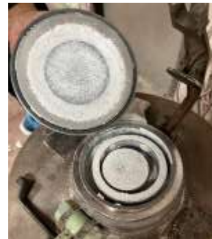
รูปที่ 3 นำเปลือกหอยที่แห้งแล้วไปบดด้วยเครื่อง Laboratory disc mill
