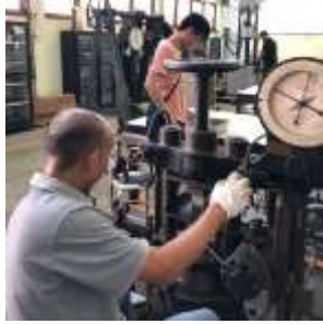
รูปที่ 9 นำก้อนมอร์ตาร์ตัวอย่างไปทดสอบกำลัง
