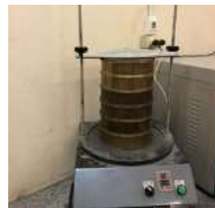
รูปที่ 4 นำผงเปลือกหอยและผงกระดูกสัตว์ไปร่อนผ่านตะแกรง
