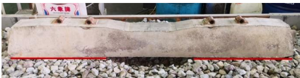
รูปที่ 11 การทดสอบในสภาวะ Unsupported at the middle
