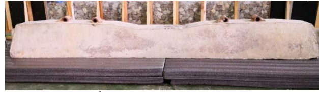
รูปที่ 4 หมอนรองคอนกรีตสภาพสมบูรณ์
