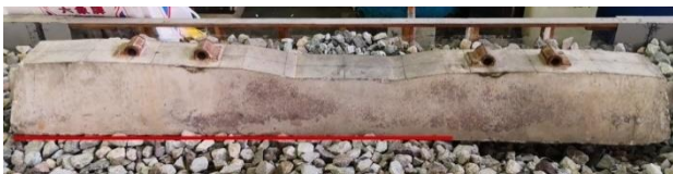
รูปที่ 12 การทดสอบในสภาวะ Overhang 33%
