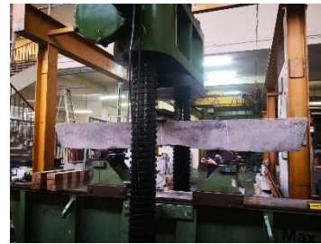
รูปที่ 5 การทดสอบ Three point bending
