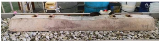
รูปที่ 9 การทดสอบในสภาวะ Full Supported Sleeper
