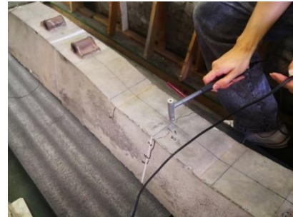
รูปที่ 2 ภาพการทดสอบโดยใช้ค้อนกระทบ
