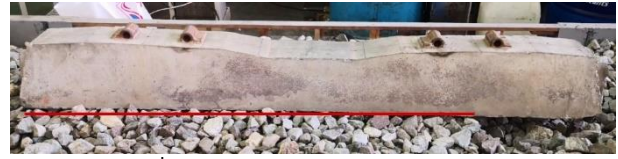
รูปที่ 13 การทดสอบในสภาวะ Overhang 20%
