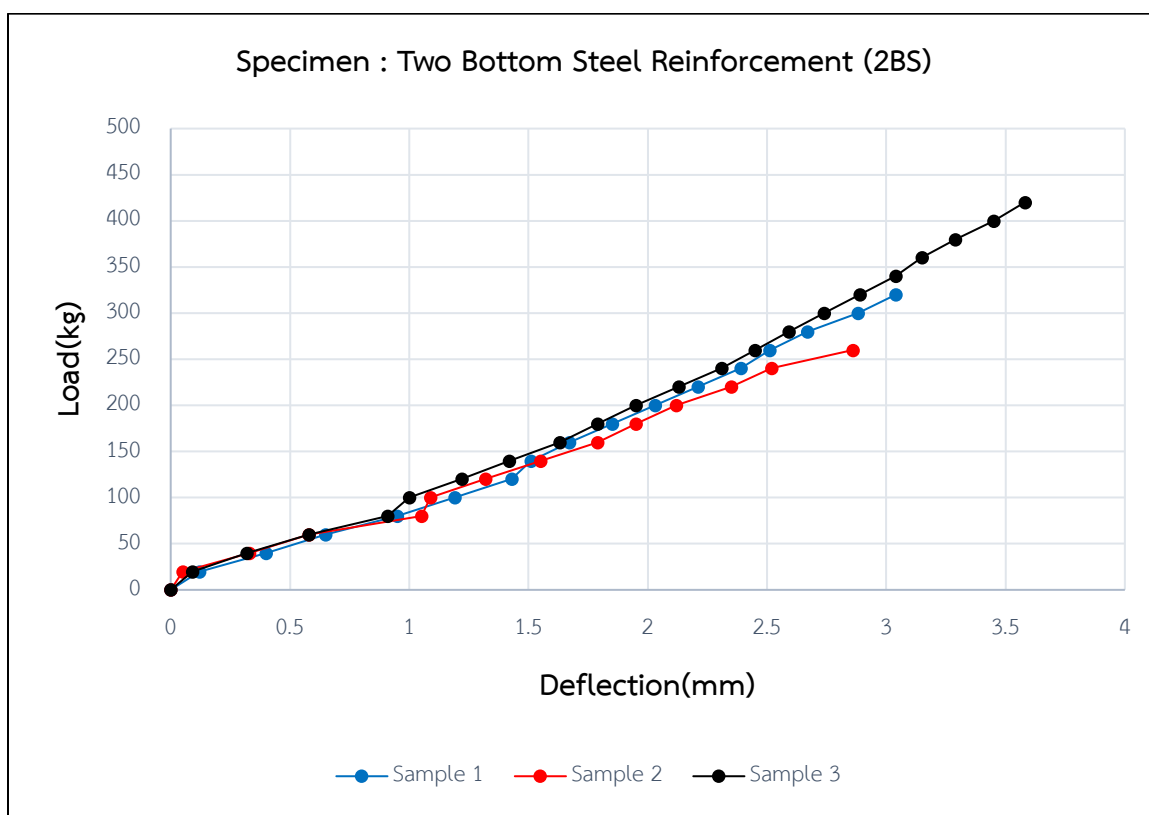
รูปที่ 4.13 ความสัมพันธ์ระหว่างน้ำหนักบรรทุกทุกกับค่าการโก่งตัวของรูปแบบที่ 4 (2BS)
