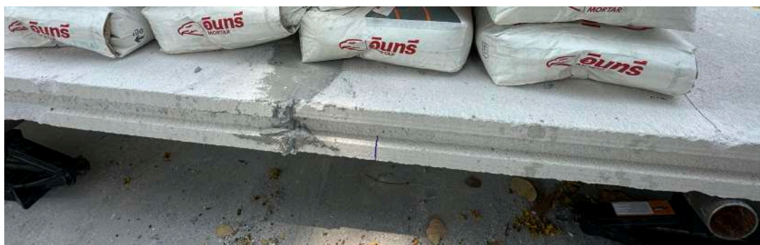
รูปที่ 4.20 ภาพถ่ายรอยแตกของรูปแบบ 2TBS ตัวอย่างที่ 3
