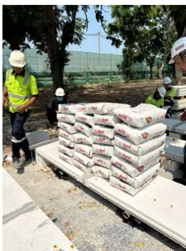
รูปที่ 3.2 ภาพถ่ายรูปแบบการจัดวางน้ำหนักบรรทุก
