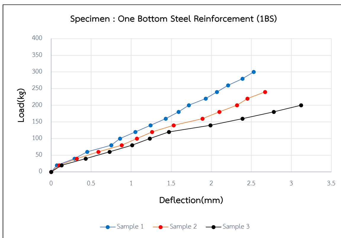
รูปที่ 4.5 ความสัมพันธ์ระหว่างน้ำหนักบรรทุกกับค่าการโก่งตัวของรูปแบบที่ 2 (1BS)
