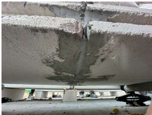
รูปที่ 4.6 ภาพถ่ายรอยแตกของรูปแบบ 1BS ตัวอย่างที่ 1
