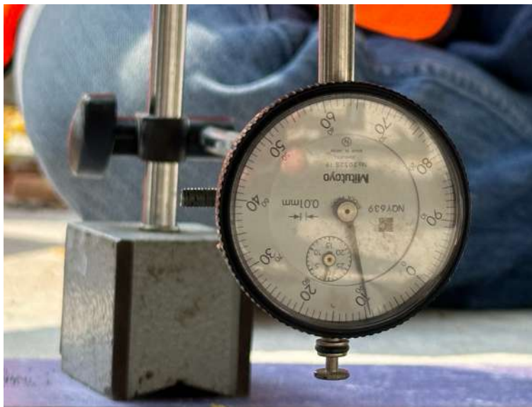
รูปที่ 3.5 ภาพถ่ายเครื่องมือวัดค่าการโก่งตัวที่ใช้ในการทดสอบ
