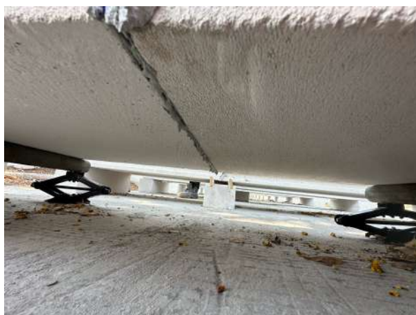
รูปที่ 4.3 ภาพถ่ายรอยแตกของรูปแบบ NSWJ ตัวอย่างที่ 2
