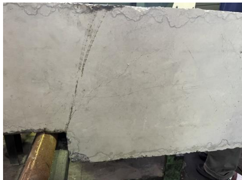
รูปที่ 8 จุดรองรับแบบบากปลายคานฝั่งซ้ายแตกร้าแบบเฉือน
