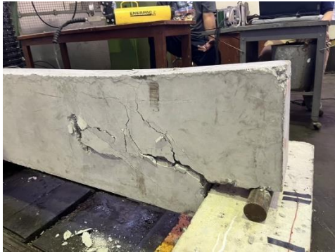
รูปที่ 7 จุดรองรับแบบบากปลายคานฝั่งขวาแตกร้าแบบเฉือน
