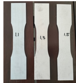
รูปที่ 5 ชิ้นงานที่ขึ้นรูปแล้วสำหรับทดสอบ Tensile Stress
