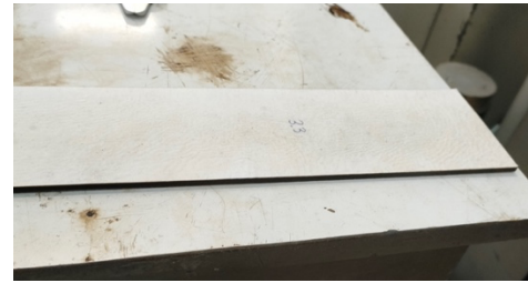
รูปที่ 4 ชิ้นงานที่ขึ้นรูปแล้วสำหรับทดสอบ Flexural Stress
