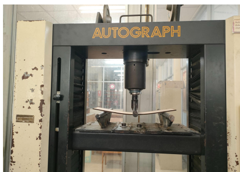
รูปที่ 12 รูปการทดสอบการรับแรงดัด
