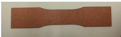
รูปที่ 1 ชิ้นงานไม้อัดผสมชานอ้อยสำหรับการทดสอบการรับแรงดึง
