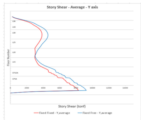
รูปที่ 10 กราฟเปรียบเทียบค่าเฉลี่ย Story Shear ทั้ง 2 กรณีในแนวแกน Y
