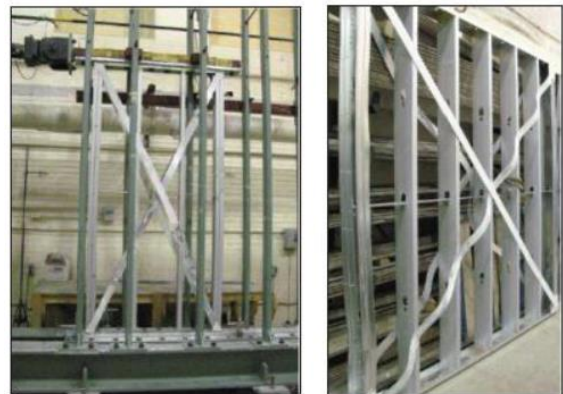
รูปที่ 6 typical strap-braced wall specimen ติดตั้งบน rig สำหรับการทดสอบ cyclic performance (ซ้าย) และการเกิด yielding ใน strap-braced หลังจากการทดสอบ (ขวา)
