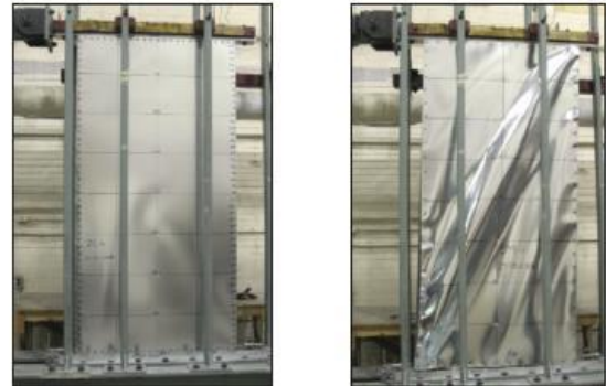
รูปที่ 5 one-sided steel sheet wall ติดตั้งบน rig สำหรับการทดสอบ cyclic performance (ซ้าย) และความเสียหายแบบ Shear buckling ในระหว่างการทดสอบ (ขวา)
