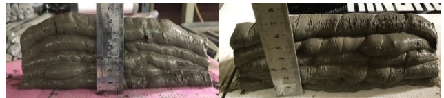
รูปภาพที่ 4.10 ตัวอย่างการขึ้นรูปสูตรผสม W440-28 และ W440-28-H01
