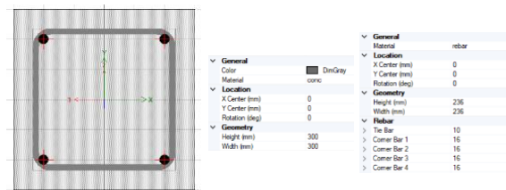
รูปที่ 32 จำลองหน้าตัดเสา C6 โดยโปรแกรม ETABS
