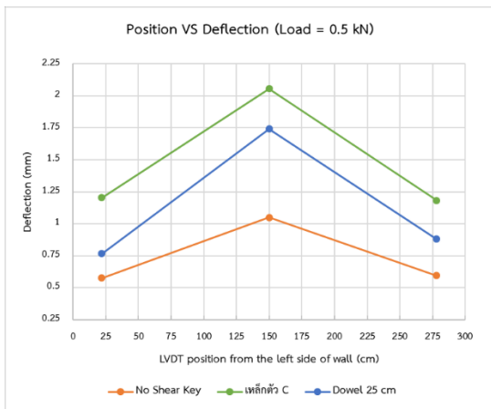
รูปที่ 16 กราฟการโค้งตัวที่ Load = 0.5 kN
