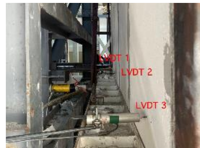
รูปที่ 9 ตำแหน่งของ LVDT แต่ละตัว
