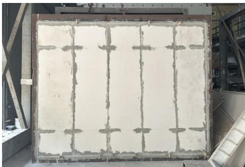
รูปที่ 2 ผนังกรณีมีเหล็กเสริมรอยต่อรูปตัว C
