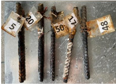
รูปที่ 11 เหล็กเสริมหลังผ่านการเร่งสนิมด้วยไฟฟ้าเคมี
