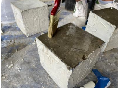
รูปที่ 4 แสดงการทาน้ำยาป้องกันสนิมลงบนก้อนตัวอย่างคอนกรีต
